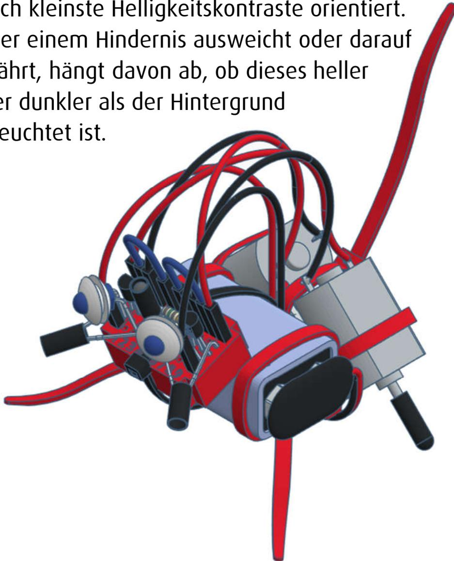
Um hingegen Hindernisse unabhängig von deren Helligkeit zu erkennen, wird in der Robotik oft Infrarotlicht oder Ultraschall eingesetzt. Sogenannte Reflexlichtschranken senden beispielsweise infrarotes Licht aus und detektieren zugleich wieviel davon von einem Hindernis zurück auf die Sensoren reflektiert wird. Mit den IR-LEDs lässt sich das Prinzip einfach aufbauen.
